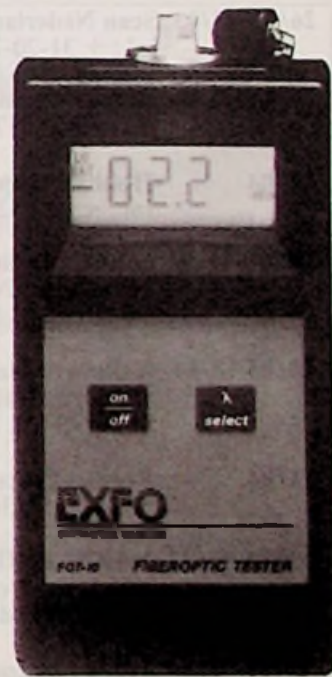
FOT powermeter van Exfo.
