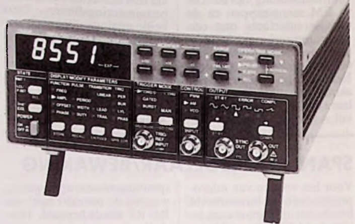
50 MHz puls/functiegenerator van Tabor.
